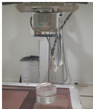
Gambar 4.1 Setup Pesawat sinar-X dengan phantom sebagai penghambur
