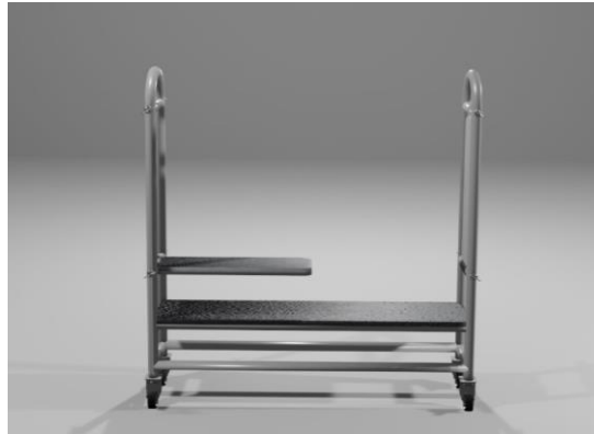
Gambar 3. 2. Desain Alat Bantu Pemeriksaan Knee Joint Erect Tampak Depan
