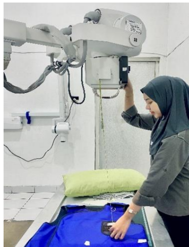
Gambar 4.2 Pengujian Lead Apron (Unit Radiologi Rumah Sakit Tingkat-III dr. Soetarto Yogyakarta, 2025)
