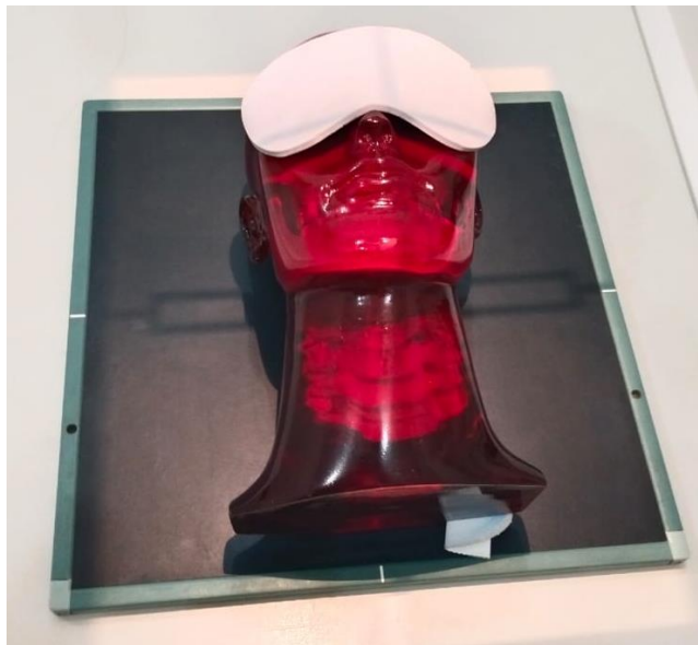
Lampiran 3.4 Pengujian Kualitas Citra Pada Phantom Kepala dengan Eyeshield
