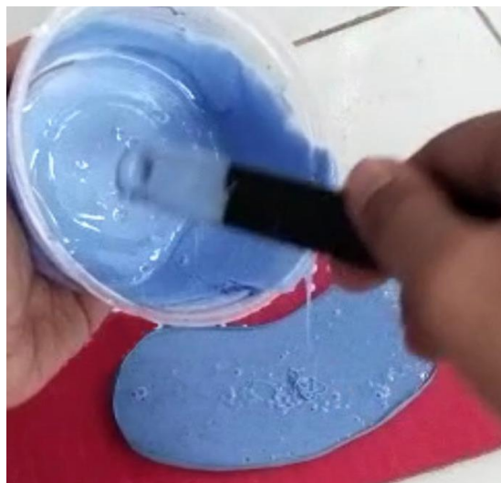
Lampiran 2.4 Penuangan Silicon Rubber RTV 48 dengan bluesil catalyst yang sudah tercampur rata ke dalam cetakan mall
