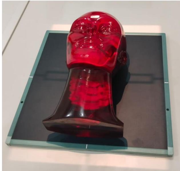
Lampiran 3.3 Pengujian Kualitas Citra Pada Phantom Kepala tanpa Eyeshield
