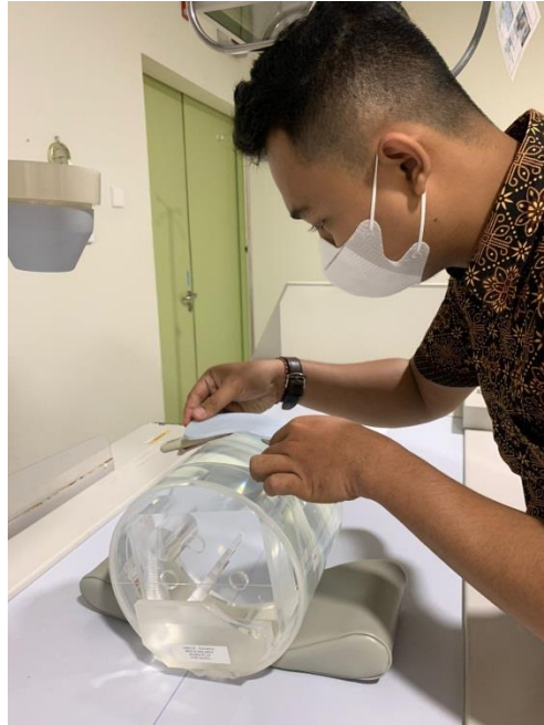
Lampiran 3.1 Peletakkan Eyeshield dan Pendose Pada Phantom
