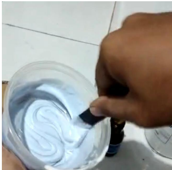
Lampiran 2.3 Pencampuran Silicon Rubber RTV 48 dengan bluesil catalyst
