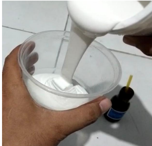
Lampiran 2.1 Penuangan Silicon Rubber RTV 48 ke dalam Cup Plastik
