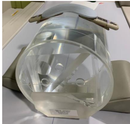
Gambar 4.4 Peletakkan Pendose dan Eyeshield Pada Phantom Kepala
