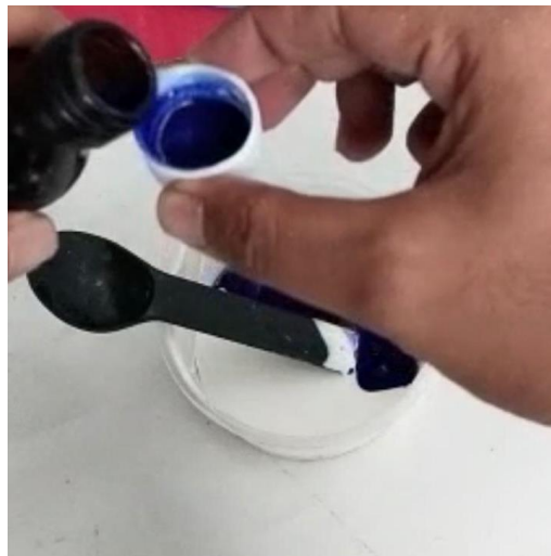
Lampiran 2.2 Penuangan Bluesil Catalyst ke dalam Cup Plastik yang telah terisi Silicon Rubber RTV 48
