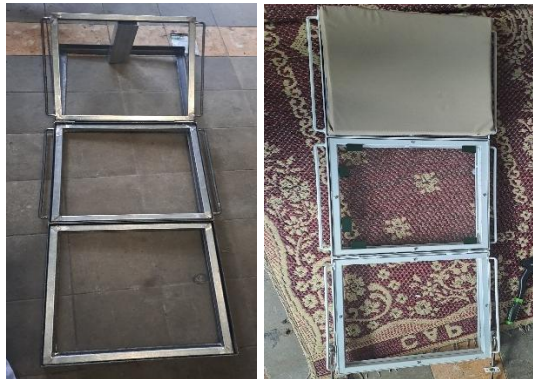
Gambar 3. 7 Proses Pembentukan Kerangka dan Pemasangan Busa
