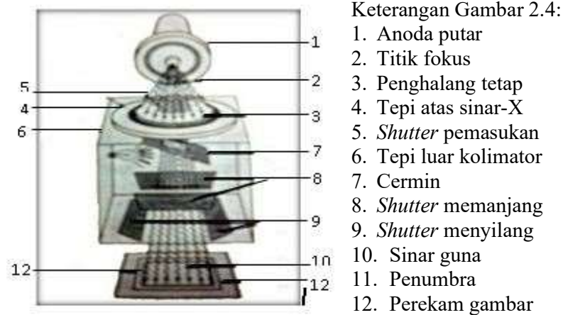
Gambar 2.5 Kolimator Tabung Sinar-X (Bushong, 2013).
