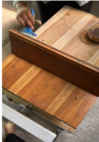
Gambar 4.2 Pembuatan alas pemeriksaan knee joint lateral stress view
