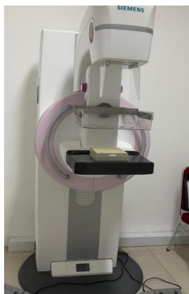
Gambar 4. 1 Setup Pesawat Mammografi Dengan Phantom sebagai Penghambur
