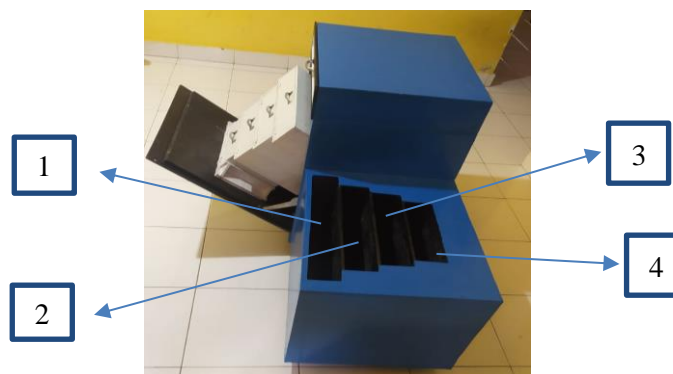
Gambar 4.3. Kotak penyimpanan film, kaset dan grid radiologi tampak samping
