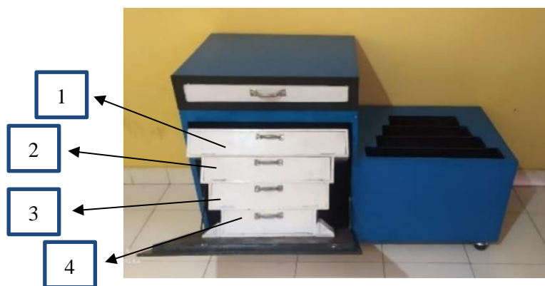
Gambar 4.2. Kotak penyimpanan film, kaset dan grid radiologi keadaan terbuka.
